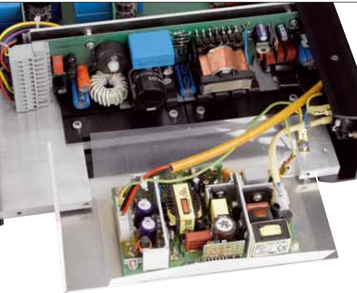
Stromversorgungs-Hightech: Der MalValve wird von einem Schaltnetzteil (hinten) mit „Power Factor Corrector“ (vorne) gespeist
